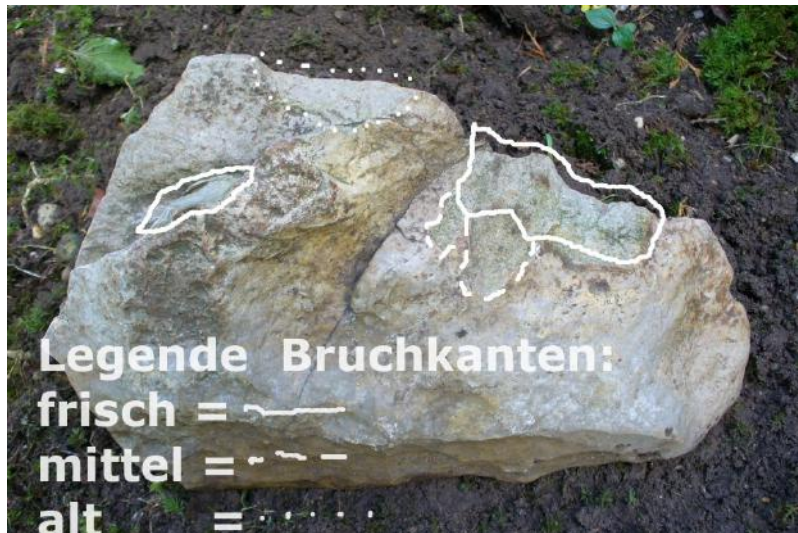
Stein in Seitenansicht mit Kennung der Bruchstellen.
